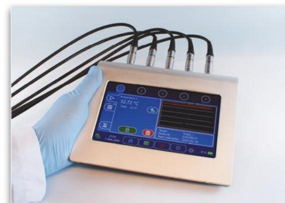
NiloChecker Equipo de medición de CO<sub>2</sub>, O<sub>2</sub>, Temperatura y Flujo de aire todo en uno.
